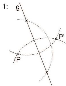
2: Zeichne je einen Kreis mit dem Radius r um die beiden Punkte. Der gewählte Radius muss dabei größer sein als der Abstand der beiden Punkte. Die beiden Kreise schneiden sich in zwei Punkten. Die Gerade durch die Schnittpunkte ist die Spiegelachse.
