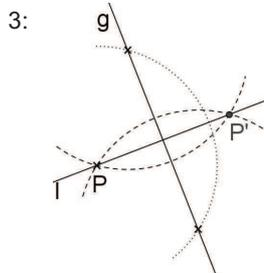
4: Es funktioniert nicht, weil P Fixpunkt der Spiegelung von P an g ist. Man zeichnet einen Kreis k um P mit einem beliebigen Radius r. Um die Schnittpunkte von k mit g zeichnet man je einen Kreis mit dem gleichen Radius R (R > r). Die Gerade durch die Schnittpunkte dieser beiden Kreise ist das Lot zu g durch P.
